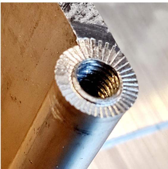
Die hohen Anziehdrehmomente der Sechskantschrauben in der Verbindung UP/RP erzeugen einen extremen Anpressdruck auf die Keil-Sperrzahnscheiben zwischen UP und RP. Es entstehen zahnförmige Deformationen im Aluminium, die eine kraftschlüssige Verbindung sehr hoher Tragfähigkeit generieren.
